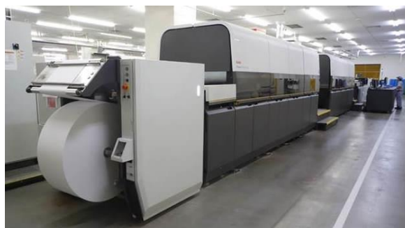
ドットコード入りオンデマンド教材の製造を高速インクジェットデジタルプリンター「プロスパープレス」で実現。
