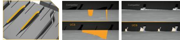
左: ダイヤモンドエッジを施したショルダー部分のイメージ 中: 従来のパターン(上)とダイヤモンドエッジパターン(下)の接地面積の差異 右: 従来のパターン(上)とダイヤモンドエッジパターン(下)の排水効果の差異
