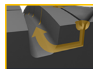
ウォーターライダーシステムにより排出される水の流れ
