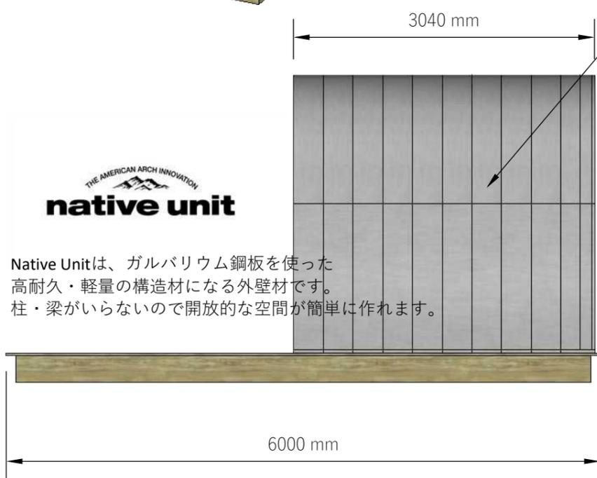
Native Unitは、ガルバリウム鋼板を使った高耐久・軽量の構造材になる外壁材です。柱・梁がいらないので開放的な空間が簡単に作れます。
