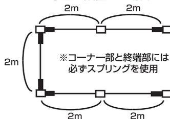
2m間隔で支柱を立て、ワイヤーを張っていきます。スプリングは4mごとに使用して下さい。例えば4mの場所に支柱を3本使って設置する場合、中央の支柱は穴にワイヤーを通すだけで大丈夫です。ただし、L字型やコの字型にワイヤーを張っていく場合は、コーナー部分には必ずスプリングを使用して下さい。また、終端部の支柱にも必ずスプリングを使用して下さい。
