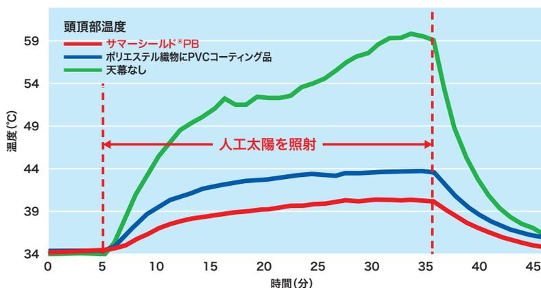
※ 試験内容: 集会用テントを想定し、試験開始5分経過時より30分間人工太陽を照射。頭部温度変化を測定した。
