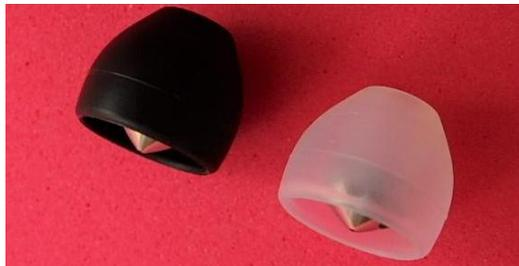
JIJUJET-2は、通常のイヤープースとは逆向きに組み付けるのが特徴。先端の音道管には金属製のフェーズプラグを組込み、カップ内の音の反射を前面方向に向ける。更にカップに小さな孔を明ける事で、音が目の前から聞こえるような『前方定位』感やコンサートホールやライブ会場で聴く事が出来るような臨場感の再現を可能としている。JIJUシリーズは2019年11月から販売を開始。
