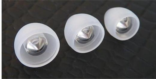
2019年11月に、頭外定位イヤープースとして販売を開始し、「JIJUJET-2」は今回で4作目の製品。「JIJUJET-2」は、現行品JIJUJETと比較し、全長を0.8mm縮め先端がカップ部から出ない仕様とした新設計のフェーズプラグを採用。プラグ先端の開口部を従来よりも約20%拡大し高音域の特性を更に改善している。又、プラグ側面にある開口径を拡大し、直接音の比率を向上させている。フェーズプラグの先端を短くしたことで、ワイヤレスイヤホンの充電時に於けるケースとの干渉も改善が見込まれる。また、カップを黒からナチュラル色へ変更している。
