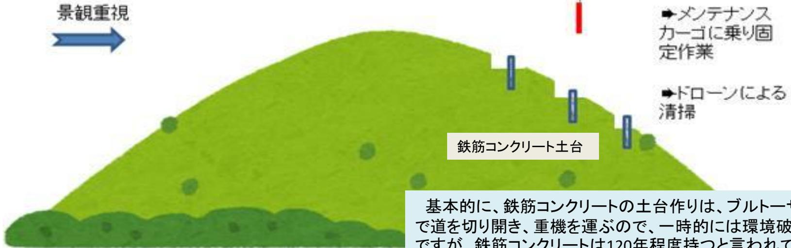
基本的に、鉄筋コンクリートの土台作りは、ブルドーザーで道を切り開き、重機を運ぶので、一時的には環境破壊ですが、鉄筋コンクリートは120年程度持つと言われているので、切り開いた道路は種々の木々や花を植え、散歩道にするとよいと考えています。(メンテ用軽トラは通る)
