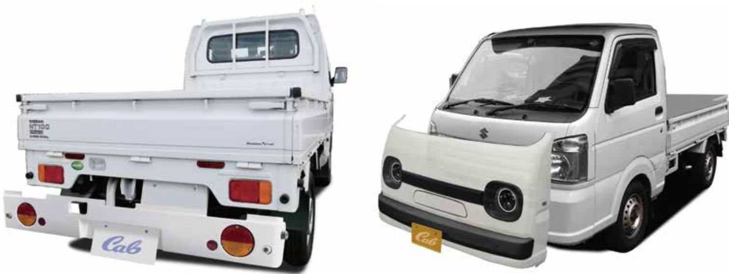
材質はFRP製(グラスファイバー、塗装無し)、部品構成はフロントマスク、ライトベゼル、フロントバンパー、5インチヘッドランプ、ウインカー、サイドマーカー、配線類、リアパネル、テールレンズ、リフレクター、ガーニッシュ(オプション)、ネジ類です。比較的簡単に組み付けが出来る様デザインしてあります。
