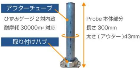
アジテータ車ドラム表面に設置された「プローブセンサー」、情報を記録、表示する「ディスプレイ」、得られた情報をクラウドに打ち上げる「インタフェイスボックス、タブレット」の、3セクションで構成。プローブセンサーには、ひずみゲージ、サーミスタ、ジャイロセンサーが内蔵されており、ドラム内の生コンクリートを横断する時の圧力、コンクリート温度、積載率等を測定します。計測データは約15秒間隔でタブレットの4G回線を経由してクラウドにアップロードされます。得られた情報は、インターネットに接続されたPC等を用い、サイトにアクセスする事でどこからでも確認ができます。
