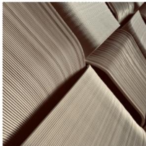
に廃棄される切削くずなどがなく、資源を能率的に使うことができます。また、材料となるプラスチックは熱を加えることで、再利用が可能です。役目を終えたKNITは、粉碎し、再びプリントすることで新たな形へとつくり替えることができます。プラスチックを廃棄せずにマテリアルリサイクルするKNITは、地球環
