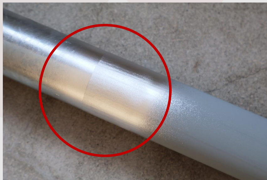
ジンクプラスネオGの上に ジンクプラスネオMを塗装
