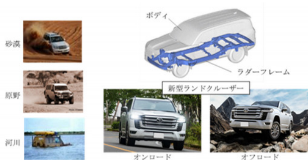
図1 ラダーフレーム構造の SUV 車
