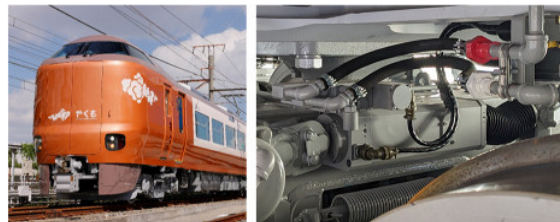
図4 273系振子電車と振子アクチュエータ
