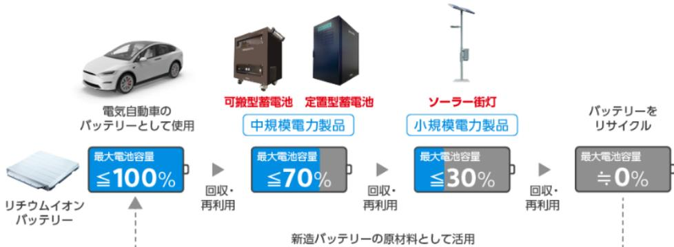
車載用リチウムイオンバッテリーにおける資源循環のイメージ
