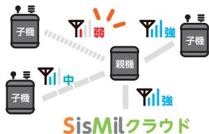
親機-クラウド/親機-子機間の電波強度を3段階（弱・中・強）でSisMilクラウド上に表示。これにより遠隔監視で通信状況把握でき、運用管理の効率化が図れます。
