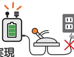
子機の電源有無を検知。電源供給がない場合、一定時間後に自動で電池モードに切り替わります。「AC電源が抜けていた!」「電池モードで設定していたつもりがACモードだった…」などのミスから運用を守ります。どの電源モードで稼働しているかは、SisMilクラウド、CSVで確認が可能です。
