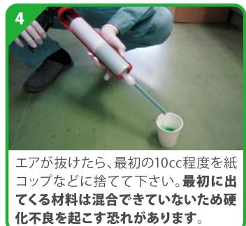
エアが抜けたら、最初の10cc程度を紙コップなどに捨てて下さい。最初に出でてくる材料は混合できていないため硬化不良を起こす恐れがあります。
