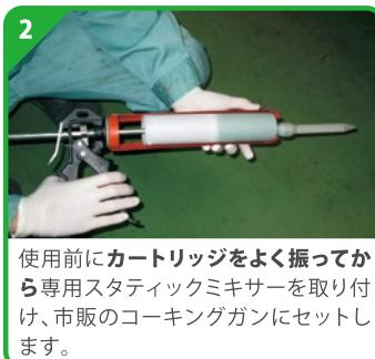
使用前にカートリッジをよく振ってから専用スタティックミキサーを取り付け、市販のコーティングガンにセットします。
