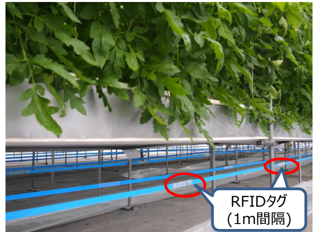
図2 農作業モニタリング環境（RFIDタグ設置状況）
